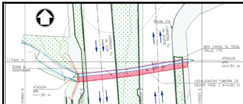
Figura 1.5. Planta general de la fase 2 del desvío de la quebrada Aguanica (canal El Redil)
